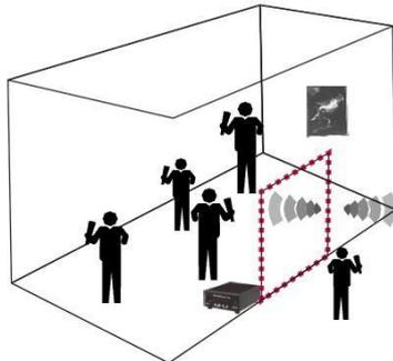
Das absichtliche oder irrtümliche Mitnehmen der Player kann durch unser Diebstahlschutzsystem verhindert werden. Dazu wird mittels unserer Diebstahlwarneinheit und eines Kabels der gewünschte Bereich abgesteckt. Sobald der abgesicherte Bereich verlassen wird, beginnt der Player zu piepsen.
